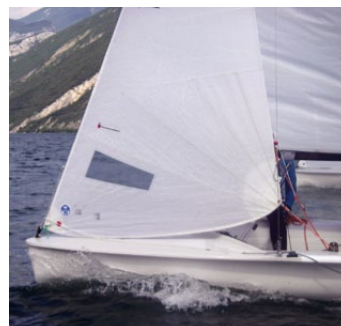
<写真D> ベースセッティング時の、適切なフットとクリューの高さ
