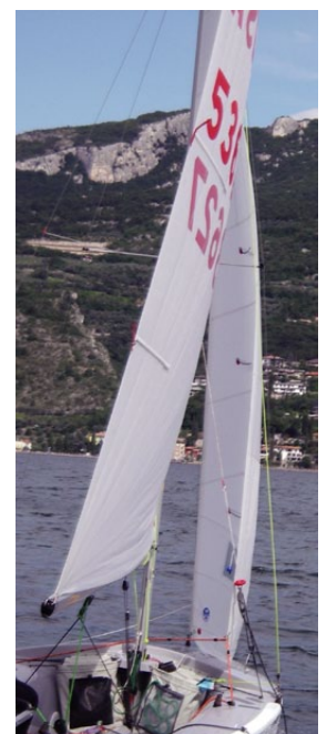
<写真C> ウインドワードシーティングによって正しくトリムされたジブのリーチ形状
